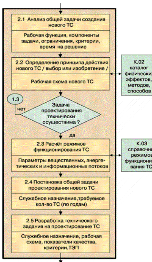
Рис. 2. Схема сист. Проект-ня СОС. 2- пошукове проектування.
