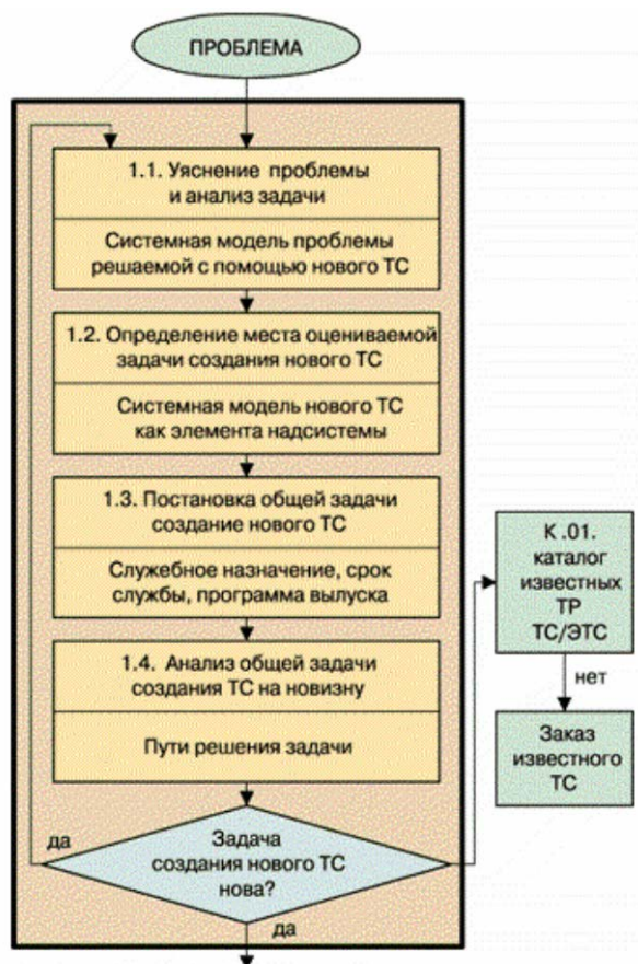
Рис. 1. Схема сист. Проект-ня СОС: 1- постановка задачі.
