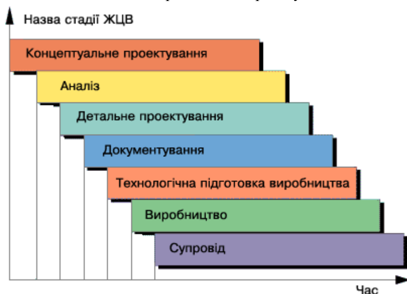
Рис. 1. Організація ЖЦВ під час паралельного проектування
